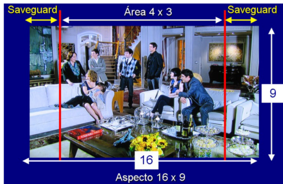
Figura 9: Saveguard aplicado em cena da novela Passione–Rede Globo Esquema produzido pelo autor
