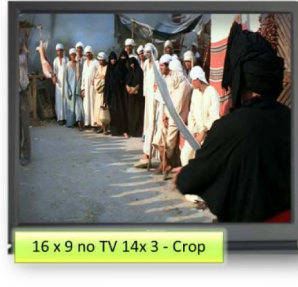
Figura 11: Imagem 16x9 na TV 4x3. Conversão: Edge Crop Esquema produzido pelo autor
